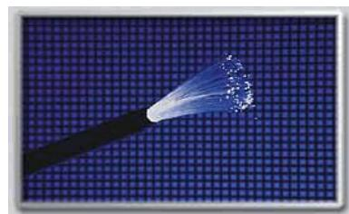
O cabo de fibra óptica é utilizado em backbones de redes de alta velocidade. Atualmente as empresas de televisão a cabo e telefonia estão substituindo as suas redes de par trançado e coaxial por redes de fibras ópticas, abrindo a possibilidade de oferta de novos serviços como a transmissão de vídeo sob demanda, áudio digital de alta qualidade e isso sem perda de qualidade ou atraso. A única desvantagem desse meio de transmissão é o seu custo que ainda é bastante alto.
