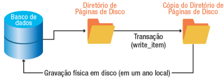
Diagrama de um diretório de páginas de disco e um diretório de sombra criado para suportar uma transação que posteriormente é gravada fisicamente no banco de dados.
