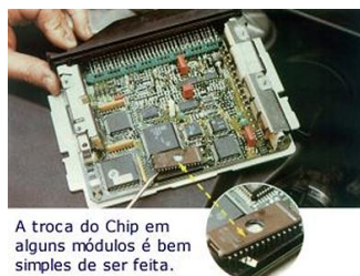
Figura: tecnologia que permite alteração de potência ou de combustível do carro
