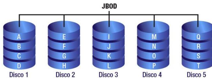
Desta forma, no padrão JBOD, caso um dos discos seja danificado, toda a informação armazenada é perdida. Além disso, não há qualquer preocupação em segmentar a informação e armazena-la em múltiplos discos como forma de melhorar a performance do sistema através do incremento das velocidades de leitura e escrita.
