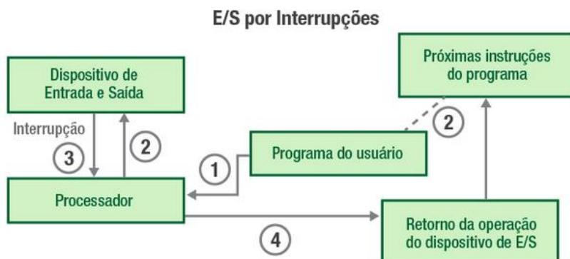
Apesar de evitar o processo de espera ativa, a CPU continua responsável por efetuar as transferências de dados entre os diversos atores do processo no modelo de entrada e saída com o uso de interrupções. O **Acesso Direto à Memória (DMA)** surgiu justamente como uma alternativa para solucionar este problema, já que neste modelo, depois de iniciada a transação, o controle da transferência dos dados passa automaticamente da CPU para o Dispositivo Controlador (DMAC).
